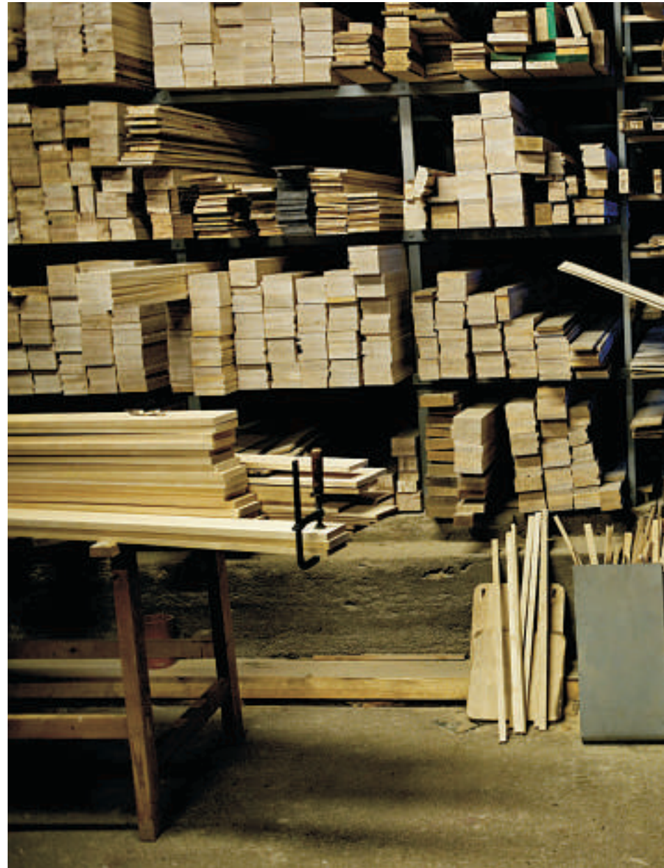
Sirlig: Hver eneste ski består av mellom 30 og 50 trebiter. Tidligere lagde Rønning til dene, men hele produksjonen, fra liming, utsaging, pussing og etterbehandling, gjøres
